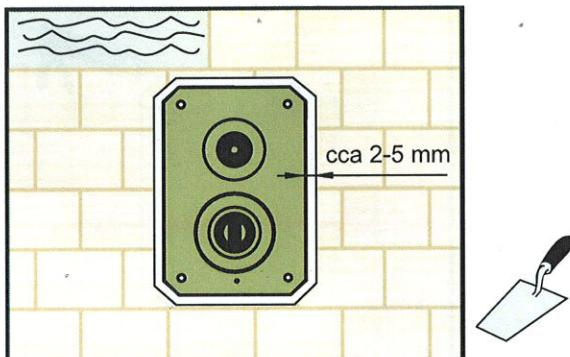
OBLOŽIT ZEĎ • OBLOŽIŤ STENU • TILE THE WALL • WYKOŃCZ ŚCIANĘ • LIPIREA PLACILOR
